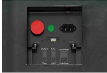
Vorne am Fahrzeug sitzt ein Fach mit Sonderfunktionen zum Anheben der Plattform und zum Lösen der Bremsen, was die Wartungsarbeiten erleichtert.
