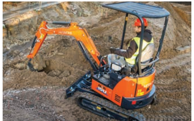
Die 3-Säulen-Schutzdachkonstruktion bietet optimale Sicht.
