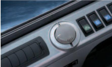
Drehzahlverstellung / Automatische Leerlauffunktion
